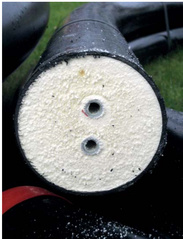
Figur 2. Tværsnit af det fremstillede prototypørør 14/14/110 mm.
